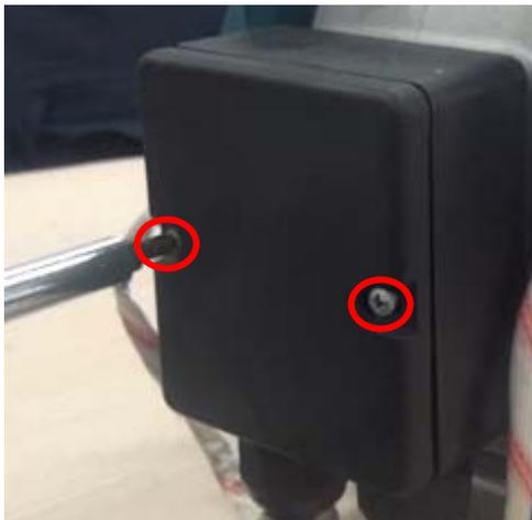
8. 在静铁芯两端装上微动开关组件，用螺钉 M4 和垫圈紧固（两端）。
