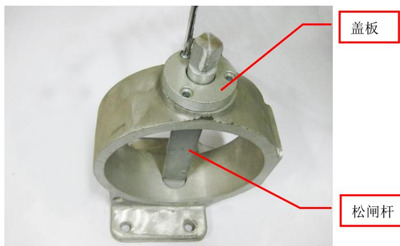
5. 清洁制动器座内孔，将动静铁芯组件装入制动器座内，螺栓 M10×110 连同平垫 10 穿过对应孔位，另一端用螺母 M10 连同弹垫 10 和平垫 10 紧固。
